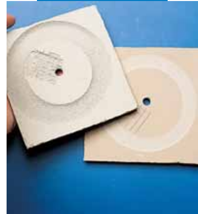
Prüfung des Verschleissverhaltens (Taber) nach 200 Umdrehungen auf Ultraplan (rechts) und auf herkömmlicher Bodenspachtelmasse
